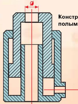
Конструкция цилиндра с полым поршнем
