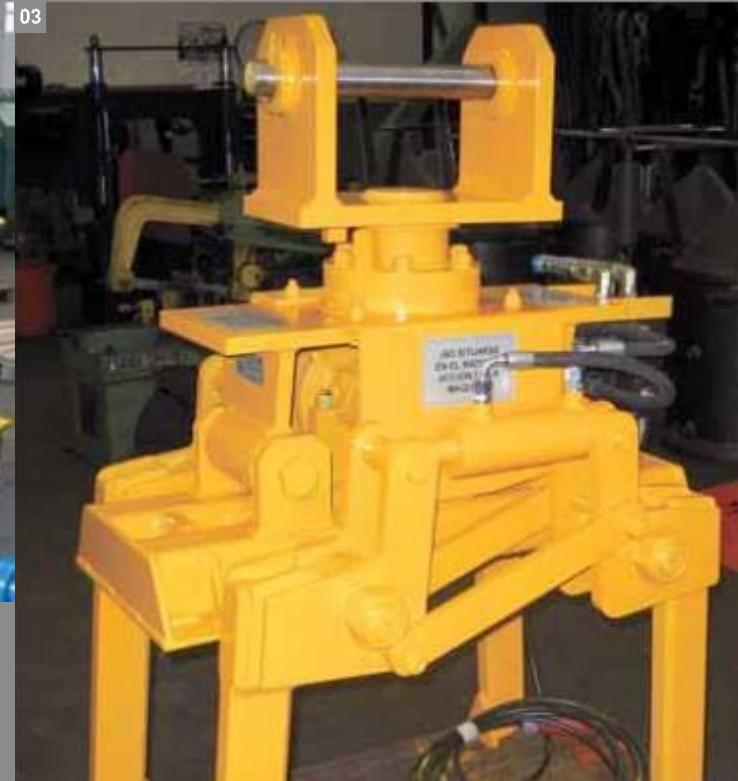
02 Специальный подъемник для лопастей ветрогенераторов массой 3,5 тонны.
